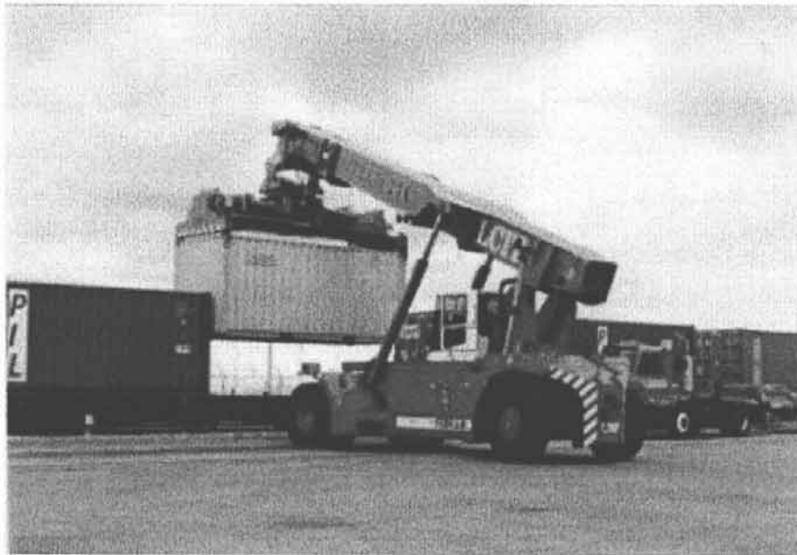
ภาพถ่ายที่ 8 : Rail Transfer ที่ท่าเรือแหลมฉบังใช้ Mobile Crane ยกคอนเทนเนอร์ขึ้น-ลงจากแคร่รถไฟ (Rail Wagon)
