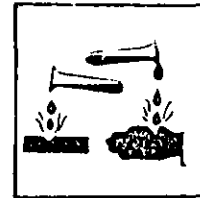
(d) Corrosive (C)
